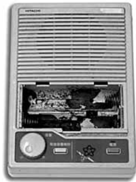
↑乾電池から液漏れして故障した例
